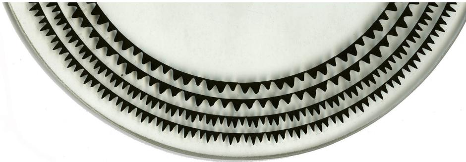
Abbildung 1.1.: Ausschnitt aus einer der bei der Lichttonorgel verwendeten Scheiben. Bild aus Dangel (2006).
